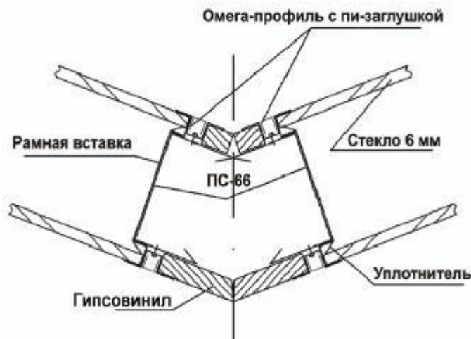
Рис.4 Схема узла остекленной перегородки с непрямым углом
